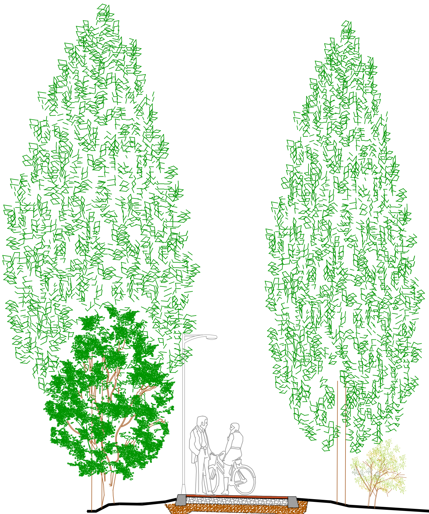
Percorso pedonale in terra battuta Collegamento tra via Paganini e viale Trieste SEZIONE TIPO
